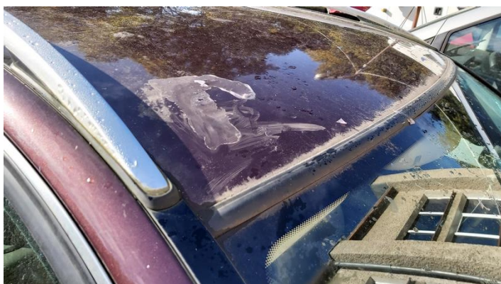
6 Dach pojazdu strona przednia prawa - zjawisko złuszczenia lakieru.
