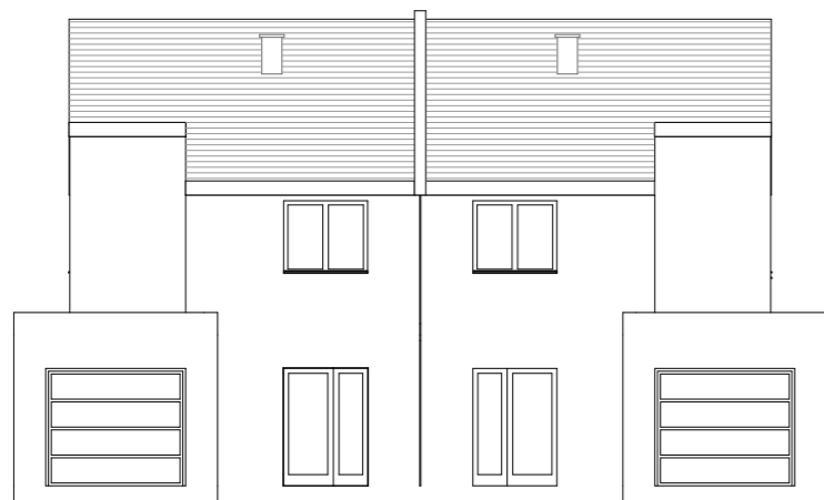
ELEWACJA FRONTOWA SKALA 1:150
