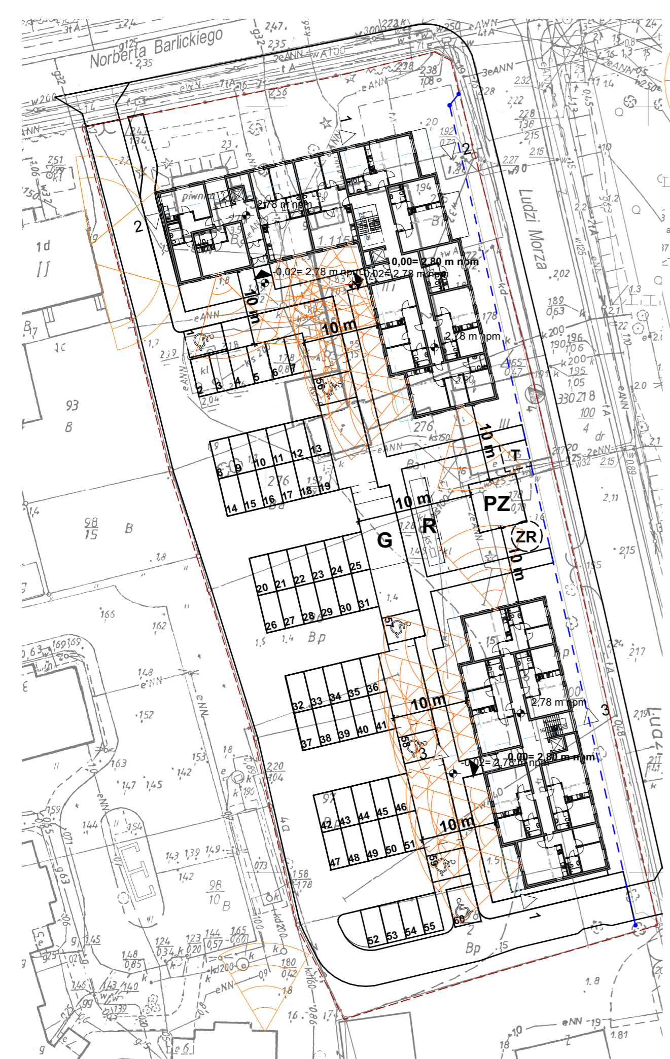
Analiza przesłaniania okien budynku Skala 1:500
