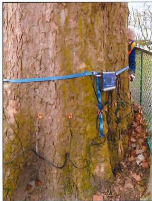
Zdj. 12. Badanie wnętrza pnia tomografem akustycznym
