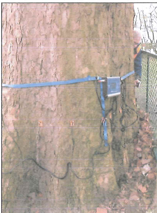
Zdj. 12. Badanie wnętrza pnia tomografem akustycznym
