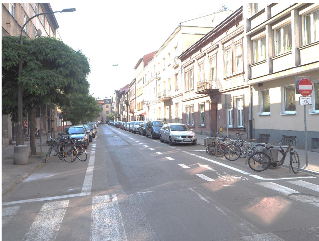
Zdjęcie 7 Lokalizacja stojaków na jezdni przed przejściem dla pieszych zwiększająca bezpieczeństwo niechronionych uczestników ruchu
