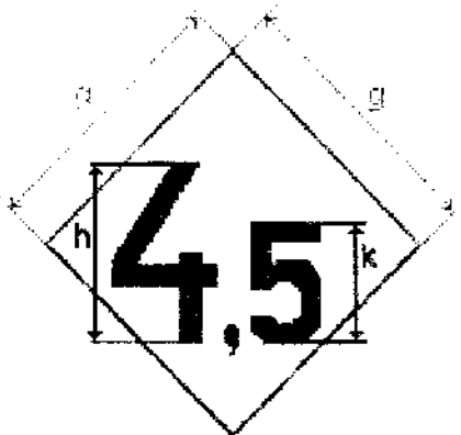
Znak typu „C” - Tablica informacyjna o prześwicie pod konstrukcją mostu dla średniego stanu wody
