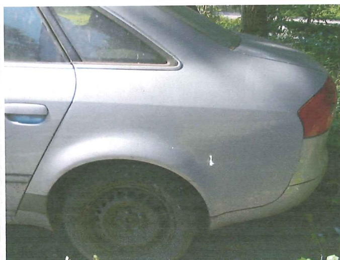
22 Poszycie t.l. - głębokie rysy powłoki lakierowej.
