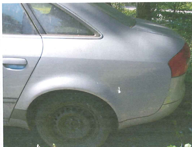
22 Poszycie t.l. - głębokie rysy powłoki lakierowej.
