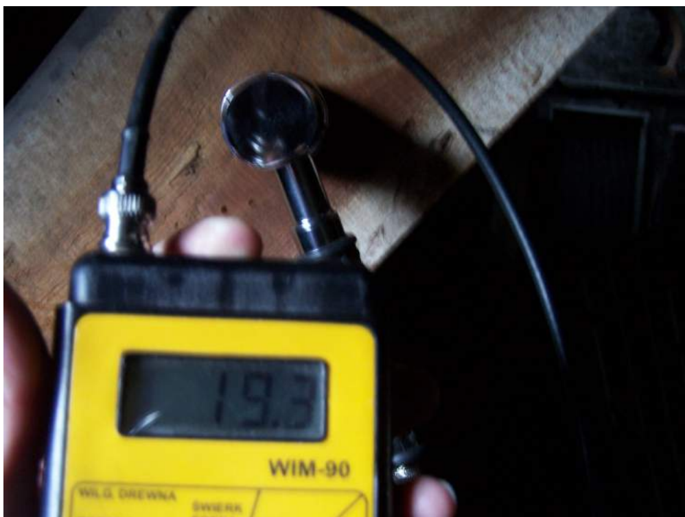
Fotografia nr 2 – Pomiar wilgotności drewna W = 19,3 \% .
