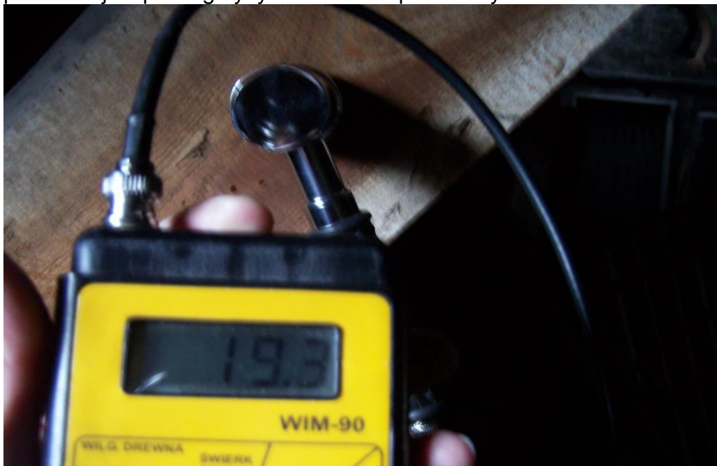
Fotografia nr 2 – Pomiar wilgotności drewna W = 19,3 \% .
