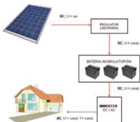
Rysunek 25 Schemat instalacji OFF-GRID 172 (oznaczenia: DC- prąd stały, AC-prąd przemienny, U- napięcie, f-częstotliwość, var.-zmiennie, const.- stałe)
