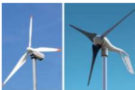
Rysunek 20 Turbiny o poziomej osi obrotu. 164
